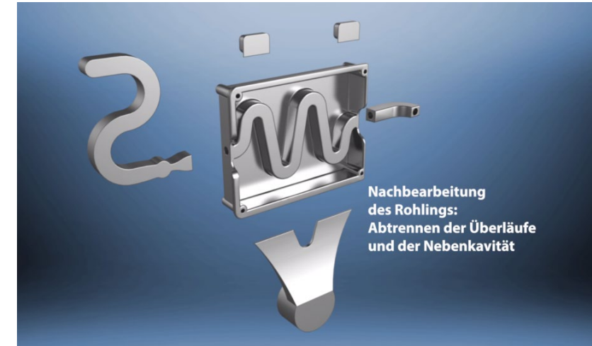
Fertiges Bauteil mit Kühlkanal
